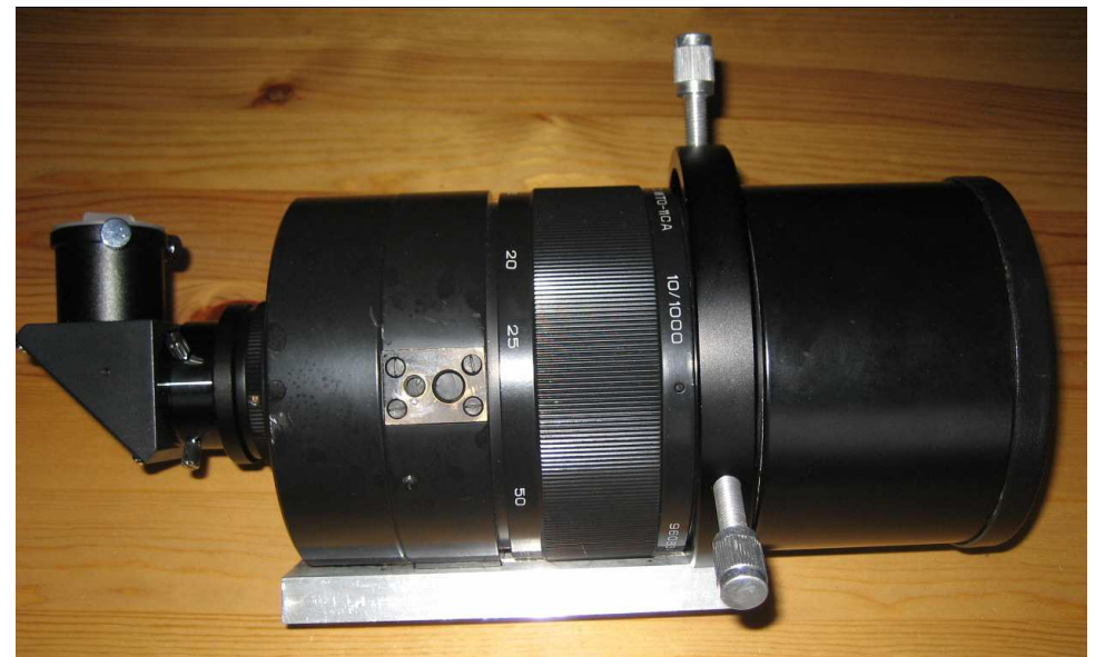
Die Russentonne ergänzt mit 1,25 Zoll Okularauszug, Zenitspiegel, Schwalbenschwanz und Rohrschelle.
